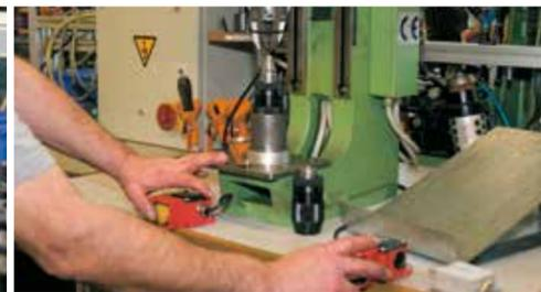
Nach der Montage wird jedes Bohrfutter nochmals sorgfältig auf seine Rundlaufgenauigkeit und Funktionssicherheit überprüft.
